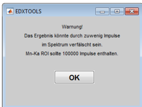
Abb. 4. Fenster mit der Warnung für den Fall eines Spektrums mit unzureichender Zählstatistik
