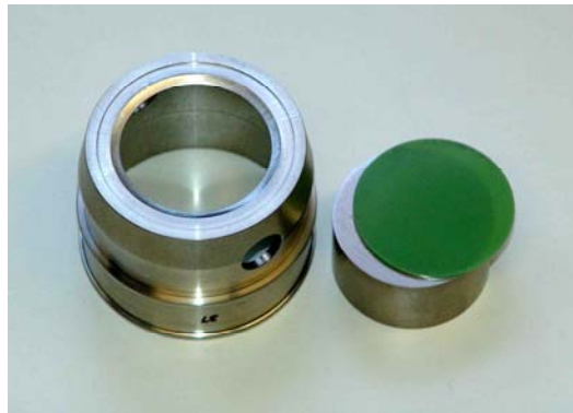
Abbildung 4 Darstellung der Probenanordnung, bei der ein Ti-Metallzylinder auf eine 1-mm-ABS-Scheibe gelegt wurde und bei der das Ti durch den Kunststoff gemessen wurde. Links sieht man den Probenhalter für die RFA
